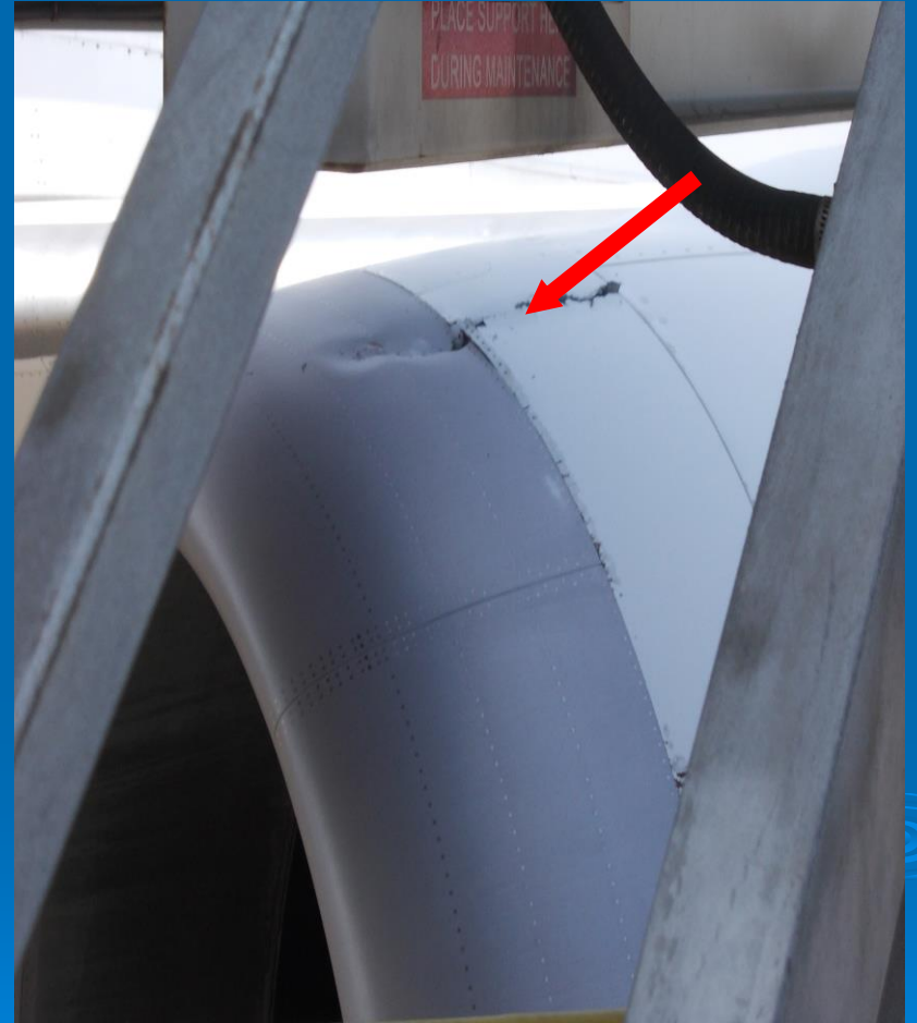
航機發動機進氣罩損傷示意照片
