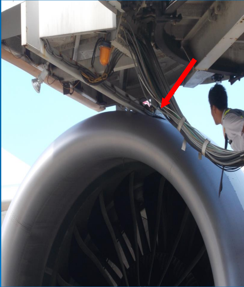
航機發動機碰觸空橋示意照片
